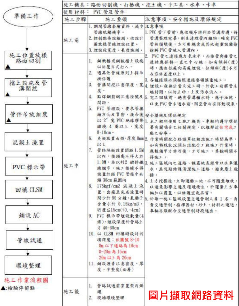
地下電纜管路工程施工流程及要領
