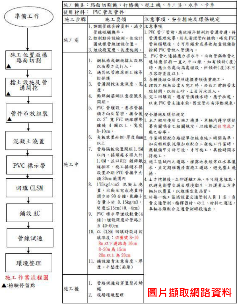
地下電纜管路工程施工流程及要領
