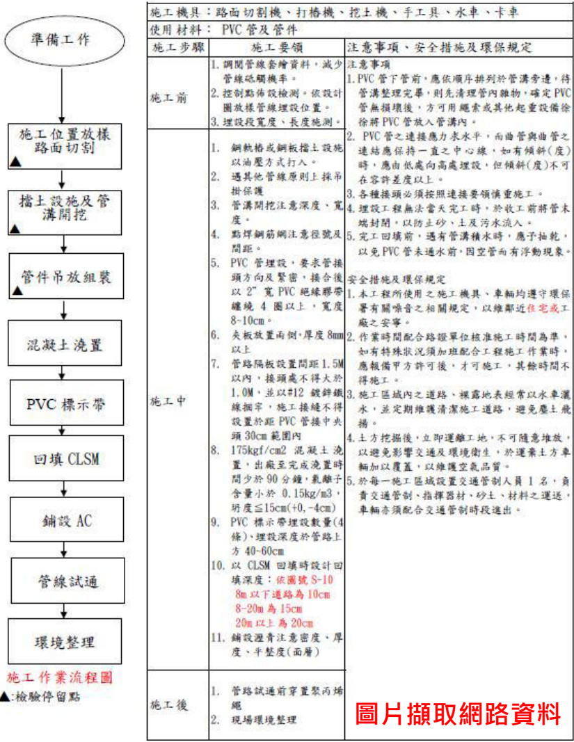
地下電纜管路工程施工流程及要領
