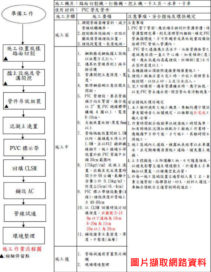
地下電纜管路工程施工流程及要領
