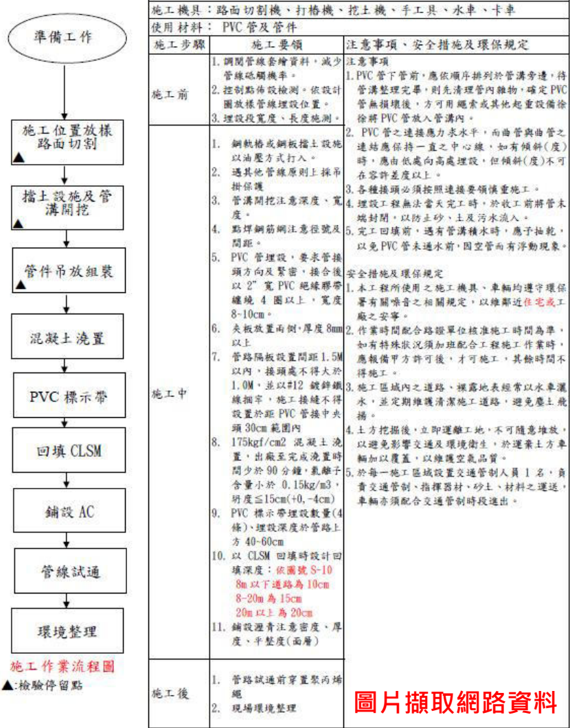
地下電纜管路工程施工流程及要領
